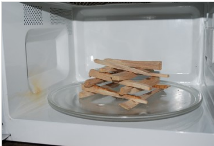
Obr. 2 Vzorek třísek před sušením v mikrovlnné troubě
